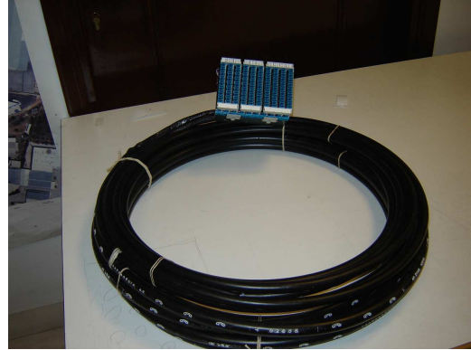
Σχήμα Α9.2.4β Προκαλωδιωμένα στοιχεία τερματισμού ΚΔ (300 ζεύγη σε monoblock 5 στοιχείων MDF splitter) και ΑΔ (50+100 ζεύγη σε BRCP-HD 160 ορίων) για χρήση σε καμπίνα Γ3.
