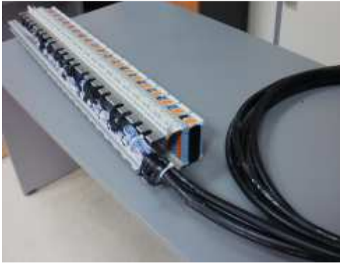
Σχήμα Α9.2.4β Προκαλωδιωμένα στοιχεία τερματισμού ΚΔ (300 ζεύγη σε monoblock 5 στοιχείων MDF splitter) και ΑΔ (50+100 ζεύγη σε BRCP-HD 160 ορίων) για χρήση σε καμπίνα Γ3.
