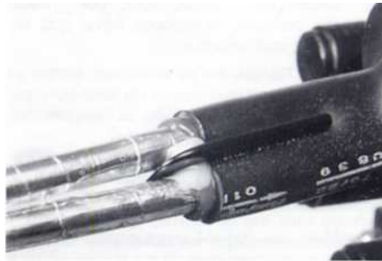
Σχήμα B2.3.17 Ολοκλήρωση διαδικασίας τοποθέτησης θερμοσυστελλόμενου σωλήνα στην οβάλ είσοδο της βάσης
