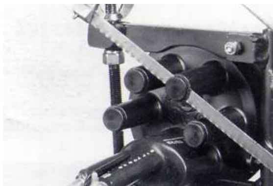
Σχήμα B2.3.33 Άνοιγμα στογγωλής εισόδου στη βάση του συνδέσμου
