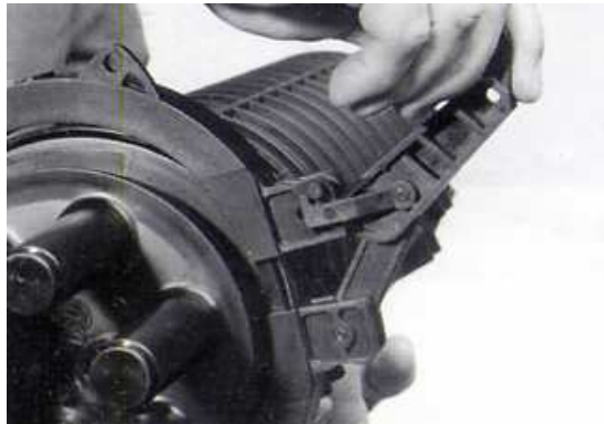
Σχήμα B2.3.2: Άνοιγμα περιβλήματος συνδέσμου
