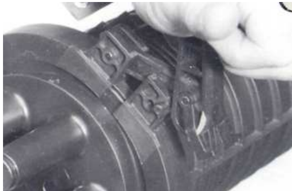
Σχήμα B2.3.30 Χρήση του κλείστρου για κλείδωμα του περιβλήματος
