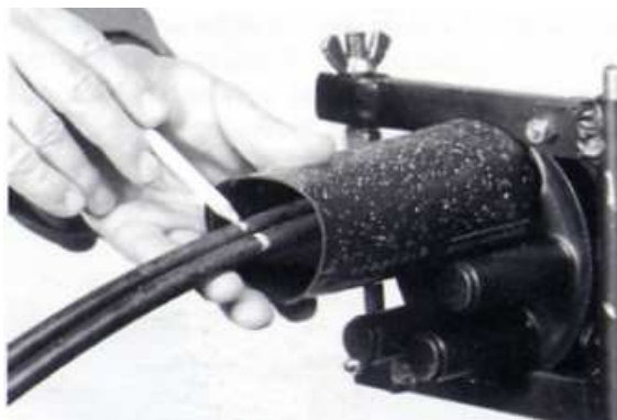
Σχήμα B2.3.13 Σήμανση άκρων θερμοσυστελλόμενου σωλήνα
