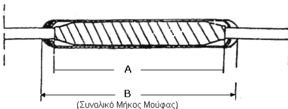
Σχήμα B1.3.6 Άνοιγμα καλωδίων και αφαίρεση μανδύα για κατασκευή συνδέσμου.
