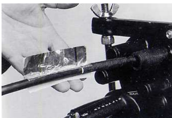
Σχήμα B2.3.39 Τοποθέτηση των φύλλων αλουμινίου
