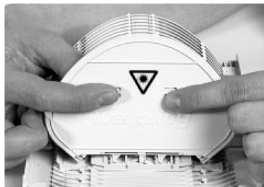
Σχήμα B2.3.22 Τοποθέτηση καλύμματος σε οργανωτήρες κορμού και πρόσβασης
