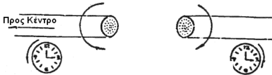
Σχήμα B1.3.10 Τρόπος αρίθμησης της σειράς των τετράδων του καλωδίου
