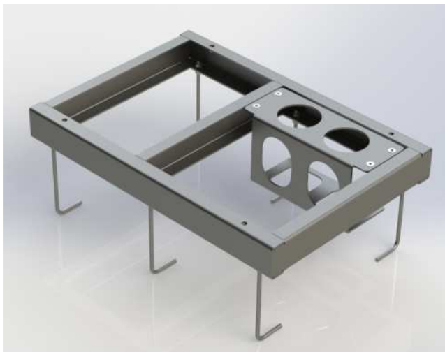
Σχήμα A.9.3.2 Μεταλλικό πλαίσιο βάσης στήριξης καμπίνας
