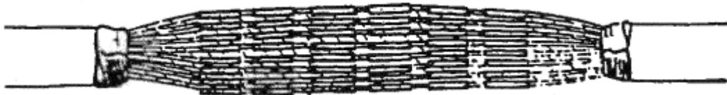
Σχήμα B1.3.11 Εικόνα συνδεδεμένων καλωδίων μετά το τέλος της πλέξης
