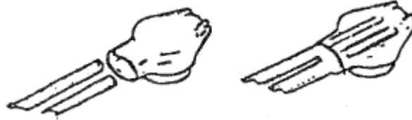
Σχήμα B1.3.22 Εισαγωγή άκρων αγωγών στον συνδετήρα
