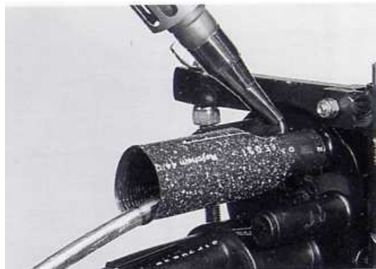
Σχήμα B2.3.40 Συρρίκνωση του θερμοσυστελλόμενου σωληνίσκου
