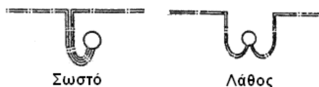
Σχήμα B1.5.15 Τρόπος εισαγωγής και εξαγωγής συνδρομητικών καλωδίων σε κουτί διακλάδωσης
