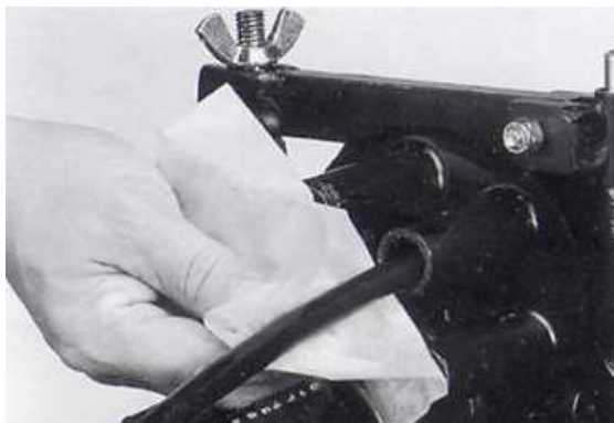
Σχήμα B2.3.37 Καθαρισμός στρογγυλής εισόδου
