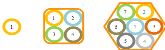
Τυπικό σύστημα πολυσωλήνων για άμεσο ενταφιασμό ( \mu D-B) με 1, 4, και 7 μικρο-σωλήνες τύπου A2 ή τύπου B2.
