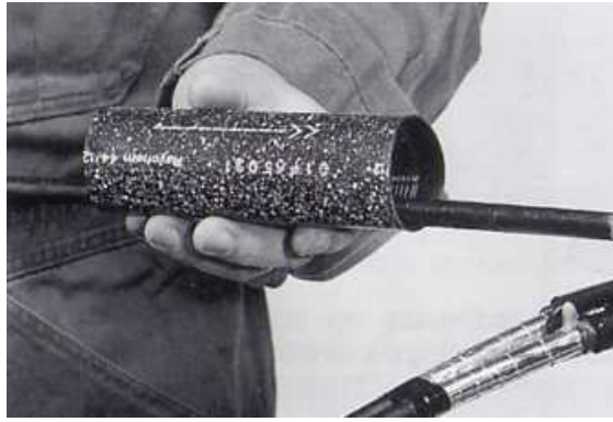
Σχήμα B2.3.34 Πέρασμα στρογγυλού θερμοσυστελλόμενου σωλήνα
