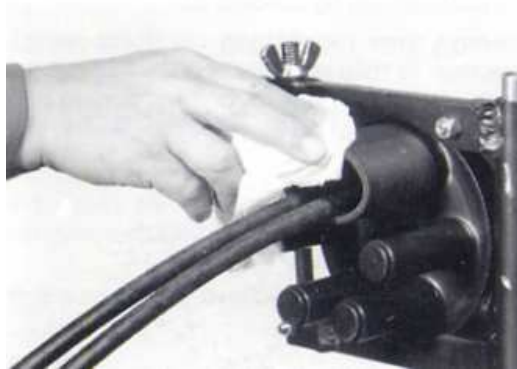
Σχήμα B2.3.10 Καθαρισμός της οβάλ εισόδου
